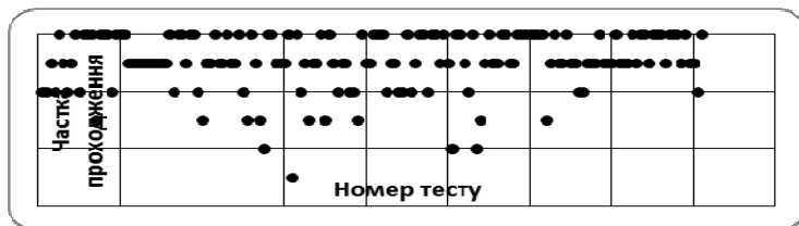
Рис. 1. Статистичний профіль вихідної послідовності шифруючого перетворення для розміру блока 256 біт
