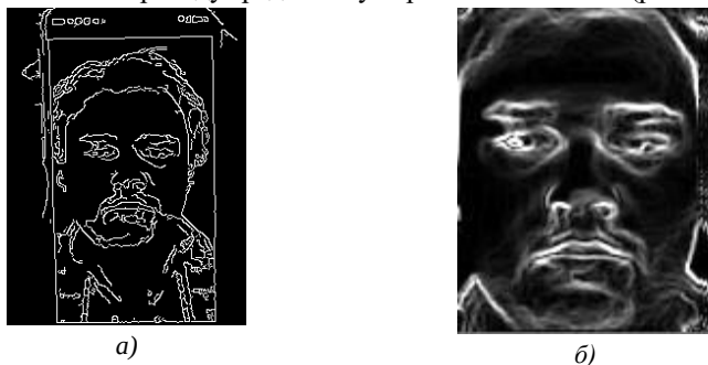
Рис. 3. Візуалізація зображення градієнтної амплітудної характеристики алгоритмом Канні
