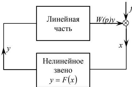
Рис. 1. Структурная схема системы с одной нелинейностью
